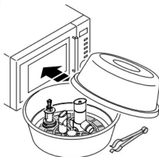
⇒ Positionieren Sie die Einzelteile mit ausreichend Abstand zueinander im Desinfektionsgerät. Falls möglich, stellen Sie die Einzelteile in die Vorrichtung, damit der durch die Mikrowelleneinwirkung erzeugte Dampf die Einzelteile optimal durchströmen kann.
