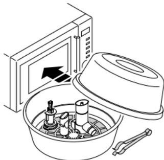
⇒ Posizionare i componenti nell'apparecchio per disinfezione sufficientemente distanziati tra loro. Se possibile, posizionare i componenti nel dispositivo in modo che il vapore generato dalle microonde possa fuoriuscire in modo ottimale dai componenti stessi.
